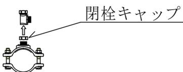
シールプラグを閉め、上部給水部分を取り外し、取り付け部に閉栓キャップをする
