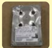
ハードディスクの破壊(穴あけ)例
