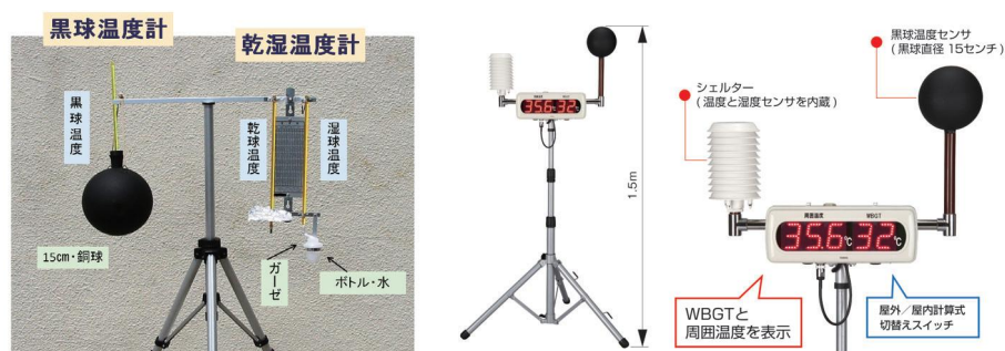
図1-18 暑さ指数(WBGT)測定装置 （左）基本型（右）電子式
