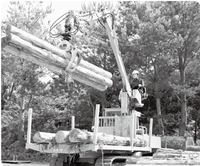
林業大学校にてフォワーダ（積載式集材車輛）の操作
