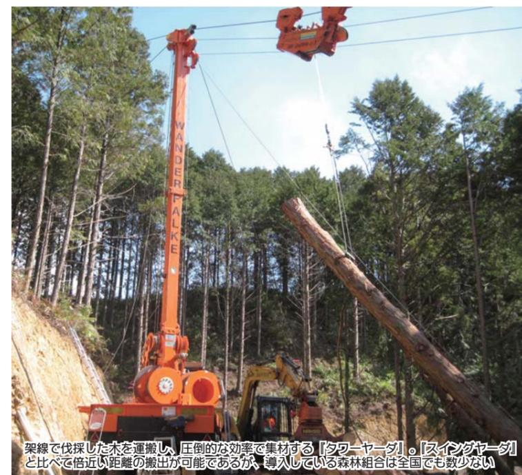
架線で伐採した木を運搬し、圧倒的な効率で集材する『タワーヤーダ』。『スイングヤーダ』と比べて倍近い距離の搬出が可能であるが、導入している森林組合は全国でも数少ない
